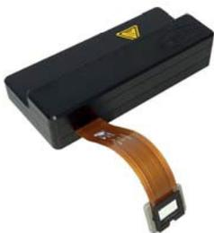
Фазовый модулятор LETO основан на отражающем микродисплее LCOS с разрешением 1920 x 1080 пикселей. С шагом пикселей всего 6,4 мкм и небольшими межпиксельными зазорами 0,2 мкм SLM LETO обеспечивают высокий коэффициент заполнения 93% и высокую световую эффективность.
