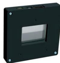
LC 2012 - это базовая система SLM, основанная на прозрачном ЖК-микродисплее с разрешением 1024 x 768 пикселей (XGA). Устройство может использоваться для фазовой или амплитудной модуляции в видимом диапазоне (однако, фазовый сдвиг может быть ограничен, например, ~2π при 450 нм, ~1,8° при 532 нм). LC 2012 использует стандартный HDMI интерфейс
