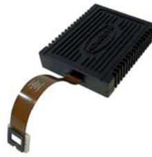
Фазовые модуляторы GAEA-2 основаны на отражательном микродисплее LCOS с разрешением 4160 x 2464 пикселей и шагом 3,74 мкм. Фазовые дисплеи могут быть с разрешением 3840x2160 пикселей или 4000x2464 пикселей при 60 Гц. Полное физическое разрешение 4160 x 2464 пикселей может использоваться при частоте кадров 58 Гц.
